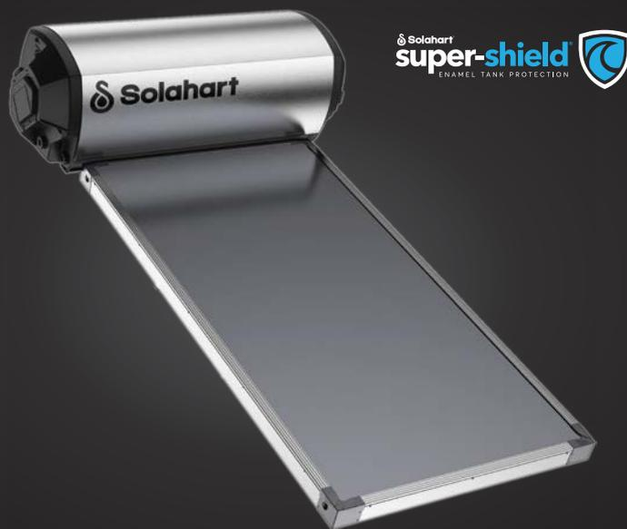
Dòng máy Premium 'L' của Solahart là máy nước nóng năng lượng mặt trời được thiết kế đặc biệt để cung cấp nước nóng ở các khu vực có bức xạ nhiệt từ mặt trời trung bình đến cao. Tấm hấp thụ bằng nhôm sơn phủ bột polyester màu đen hấp thụ bức xạ nhiệt của mặt trời và truyền vào nước trong các ống dẫn bằng đồng. Nhiệt độ tăng làm cho nước nóng dâng lên và di chuyển vào bình chứa nơi nó thay thế nước lạnh hơn, nước lạnh sau đó đi ngược vào lại các tấm thu nhiệt để được làm nóng bởi mặt trời.
